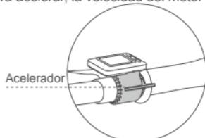
Presione el acelerador con el pulgar derecho, entonces la velocidad de motor se aumenta. Suéltelo y se vuelve a cero.
